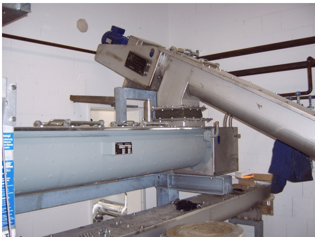
Промежуточный шнек с устройством постсушки и шнек для охлаждения
